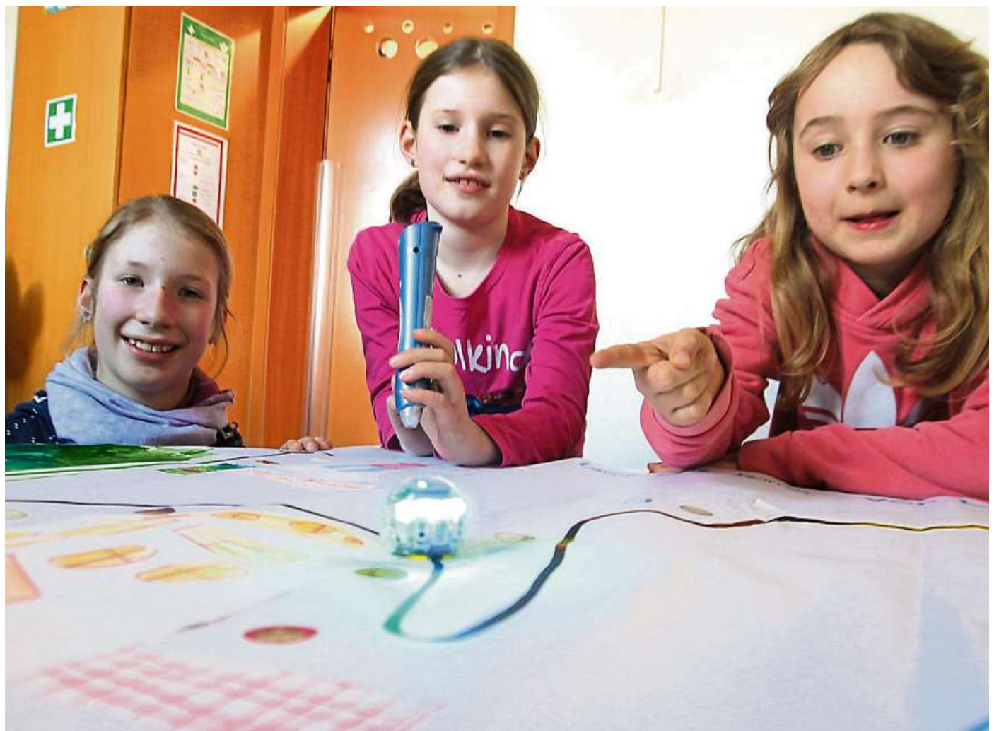
Über Sensoren an seiner Unterseite liest der Ozobot aufgebrachte Farben und programmierte Befehle ab und erzählt so dann eine Geschichte. Foto: Jörg Henkel/hbz
